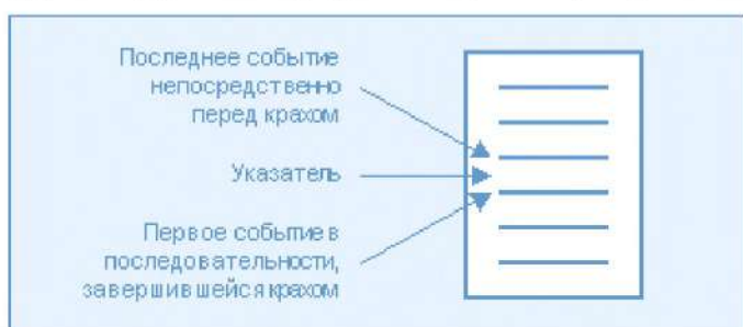
Рис. 5. Последовательность событий в кольцевом буфере
